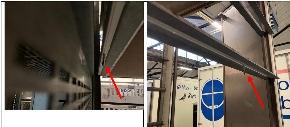
Positie temperatuur sensor (halverwege de mand)
